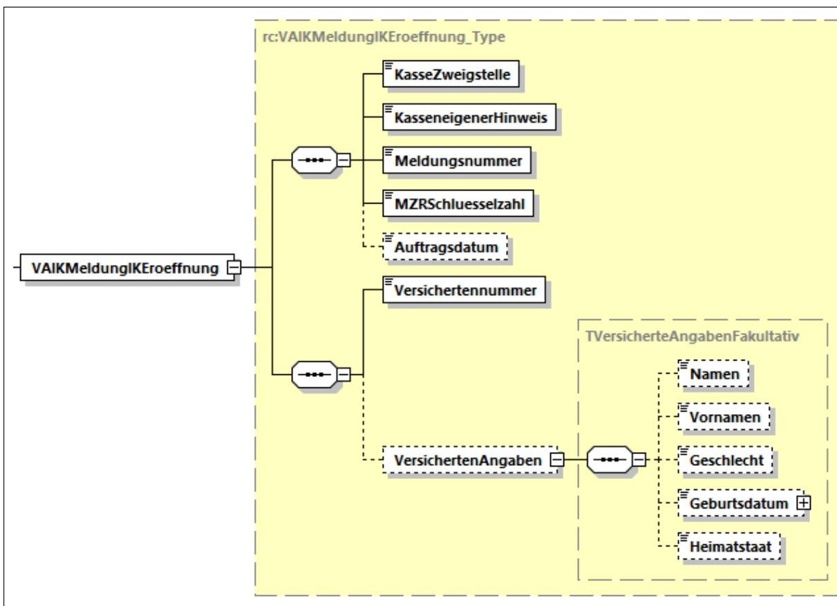
Figure 4: Schéma « Ouverture CI »
